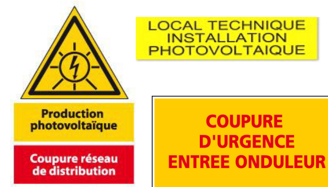
Figure 207 : Exemples de signalisation sur une installation photovoltaïque (Source : www.etiquette-photovoltaïque.com)
